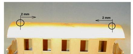
**Befestigung** auf dem Lenz-Fahrgestell: 4Stck M2 Zylinderkopfschrauben in Markierungen auf der Rückseite Bodenplatte löten und Wagenkasten von unten mit Mutter sichern. Dächer von den Strinseiten mit 1 mm Blechschrauben fixieren.
