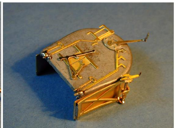
Kessel mit Schraube durch den Boden auf Lokorahmenplatte befestigen.
